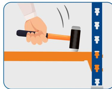
• Utilisez un marteau en nylon pour mettre correctement les lisses
